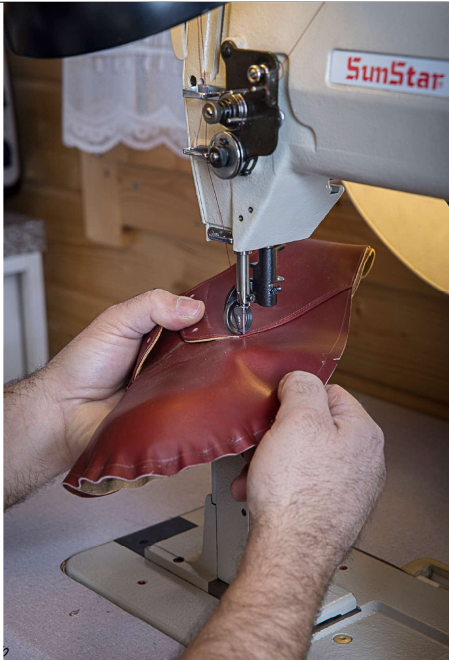
Die aus dem gefärbten Leder nach den Schablonen ausgeschnittenen Teile des Oberteils werden zusammenge­näht.
