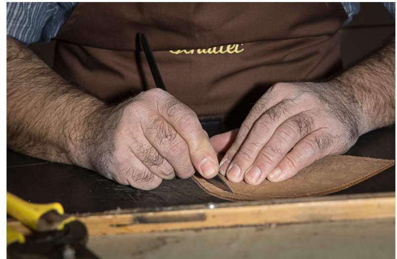
Zunächst wird das Afterleder (die Hinterkappe), dann die vordere Kappe zugeschnitten und geschärft.
