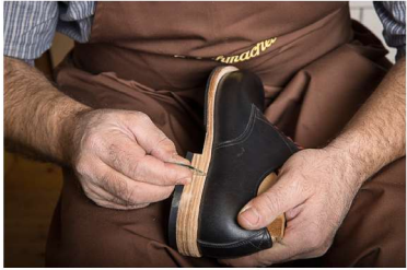
Der Lederrand an Schnitt und Absatz wird geglast, also mit einer Glasscherbe feingeschliffen.
